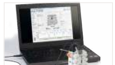
Arabirim Konfigürasyon Yazılımı, 750-923 USB Haberleşme Kablosu ile
