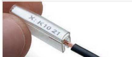
Kovanı sıkıştırın ve etiketlenecek iletkenin üzerine kaydırın.
