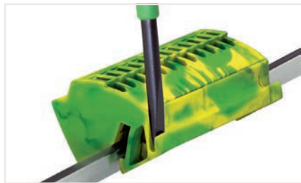
Topraklama barası klemensi çıkarmak için sağ ve sol konumların kilidini açın. Ardından bloğu baradan yukarı çekin.
